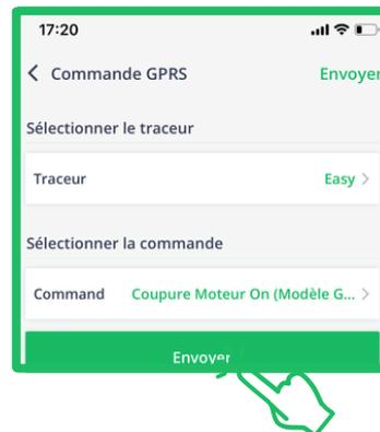
**Attention la commande ne peut être envoyée que lorsque le véhicule est en ligne, c'est à dire lorsque le contact est mis ou dans les 10 minutes qui suivent la la coupure du contact**
